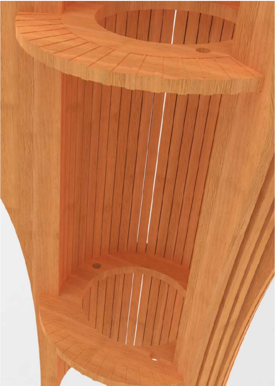
Cada plano se encaja en un rebaje preciso fresado en el anillo central.
