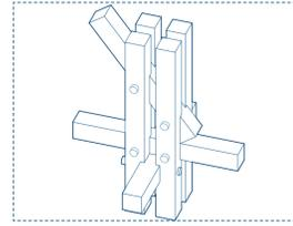
Pilar compuesto de 4 piezas + Diagonal + Tarugo
