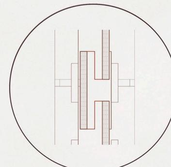
CLT de 30cm - 7 capas. Unión transversal solapada.
