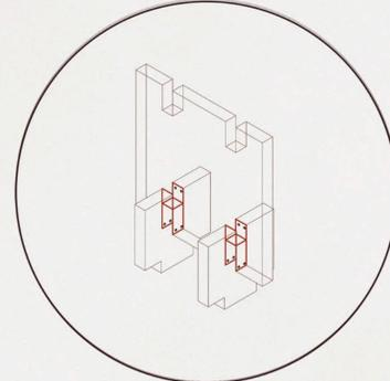
Placa metálica de refuerzo para encajes 5mm tornillos de 4.5mm.
