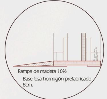
Rampa de madera 10%. Base losa hormigón prefabricado 8cm.
