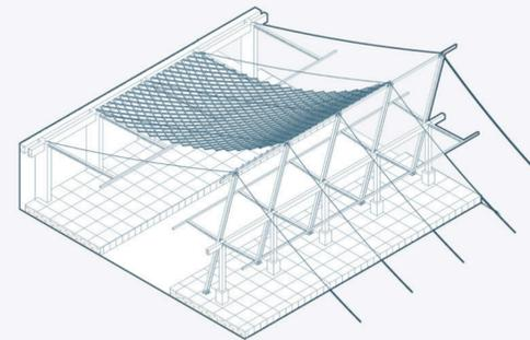
Conformado el módulo que responde al ancho de la estación, se comienza la instalación longitudinal del módulo.
