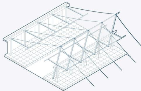
Instalación de diagonales de madera piezas 2x6" para soporte estructura modular de cubierta nueva.
