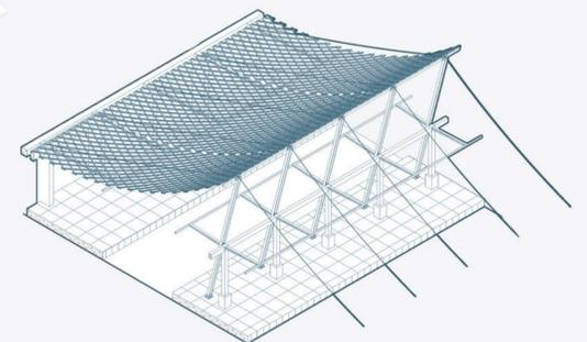
Finalización de instalación, modulación de entramado de 8,2m de ancho sostenido en diagonales de madera.
