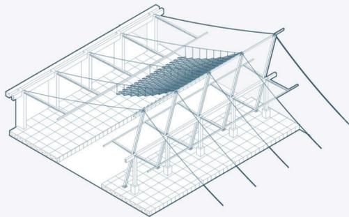
La instalación de la nueva cubierta consistirá en módulo conformados por entramados de madera previamente unida.
