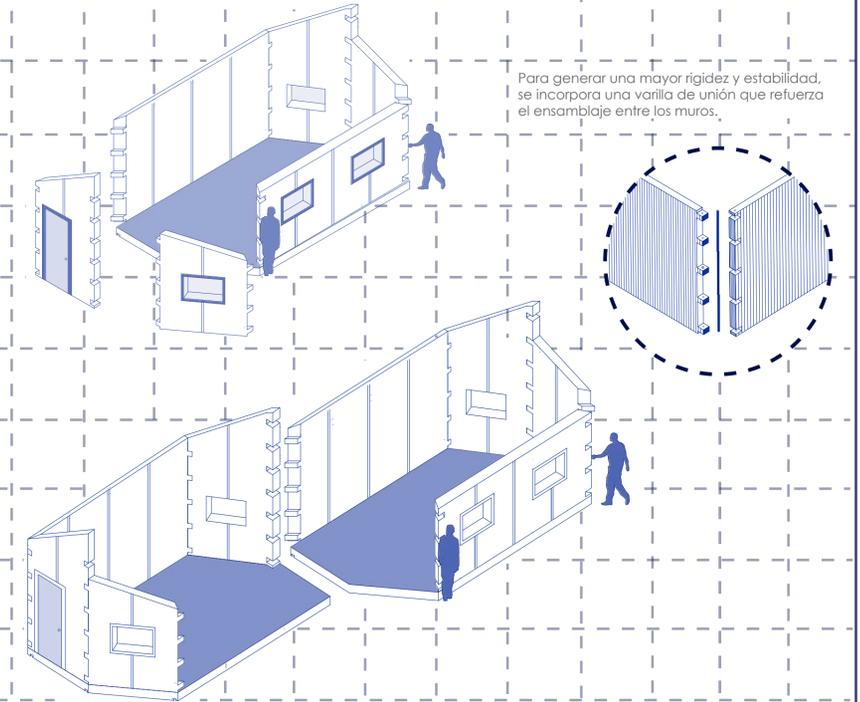
Para generar una mayor rigidez y estabilidad, se incorpora una varilla de unión que refuerza el ensamblaje entre los muros.
