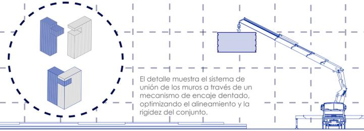
El detalle muestra el sistema de unión de los muros a través de un mecanismo de encaje dentado, optimizando el alineamiento y la rigidez del conjunto.
