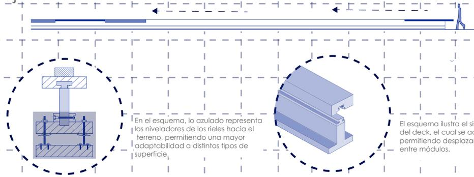
En el esquema, lo azulado representa los niveladores de los rieles hacia el terreno, permitiendo una mayor adaptabilidad a distintos tipos de superficie.
