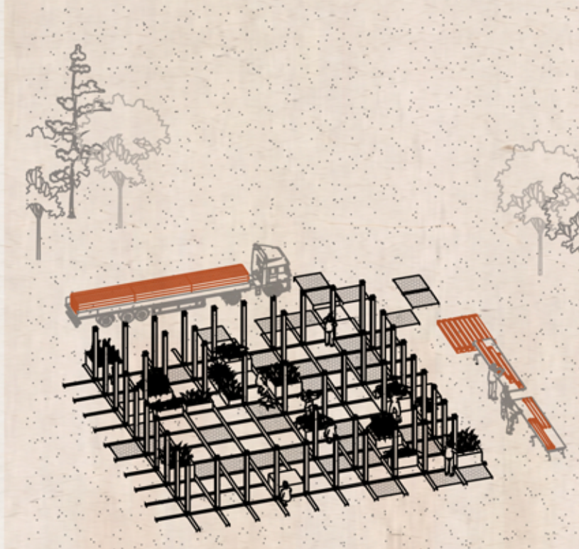
3.Dimensionado y levantamiento de los pilares
