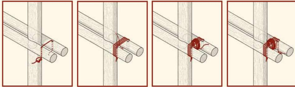
El sistema de amarre consiste en un único nudo que comprime vigas perpendiculares sobre un sacado, generando presión para sostener firmemente pilares y diagonales. Esta técnica se repite en toda la estructura como sistema constructivo modular, reversible y de fácil montaje.
