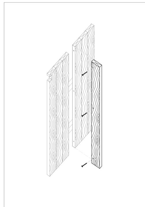
DETALLE 3 ENSAMBLE LISTONES PERIMETRALES ESC. 1:2
