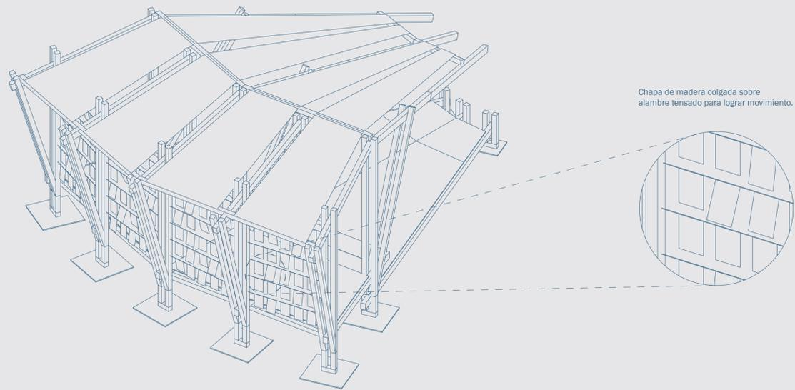
Chapa de madera colgada sobre alambre tensado para lograr movimiento.
