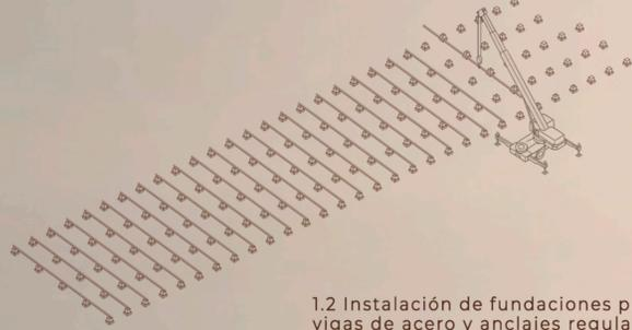
1.2 Instalación de fundaciones prefabricadas con vigas de acero y anclajes regulables.
