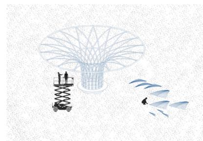
MADERA MICRO LAMINADA EN LA ESTRUCTURA.
