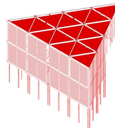
1. DISPOSICIÓN DE UNA RETÍCULA ESTRUCTURAL-MODULAR EN BASE A LISTONES DE MADERA
