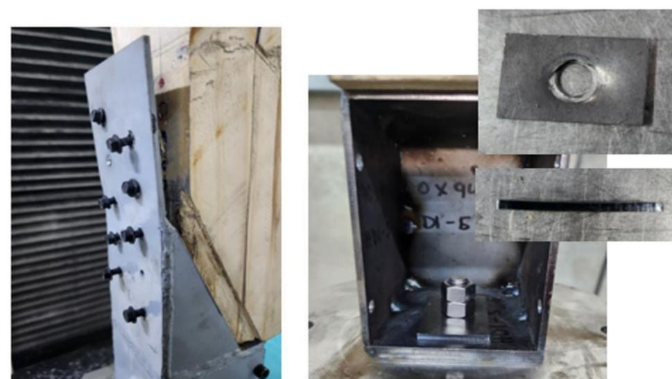
Figura 5: Mecanismo de falla para variante Corte Simple 1 (CS-1).
