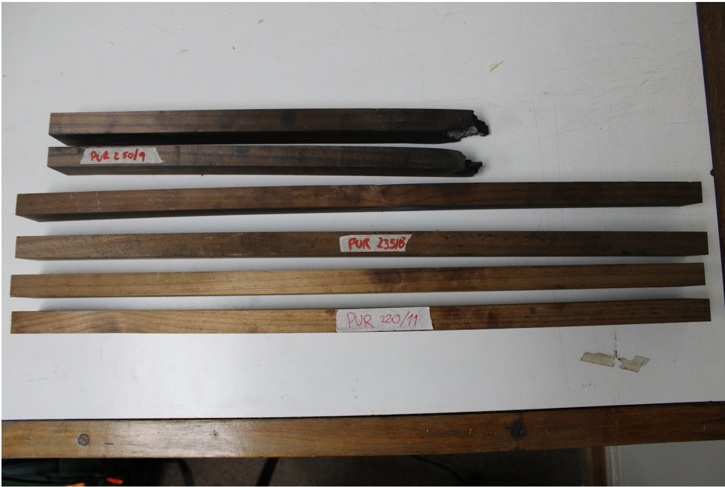
Figura 3. Delaminación en probetas con adhesivo PUR (falla adhesiva)
