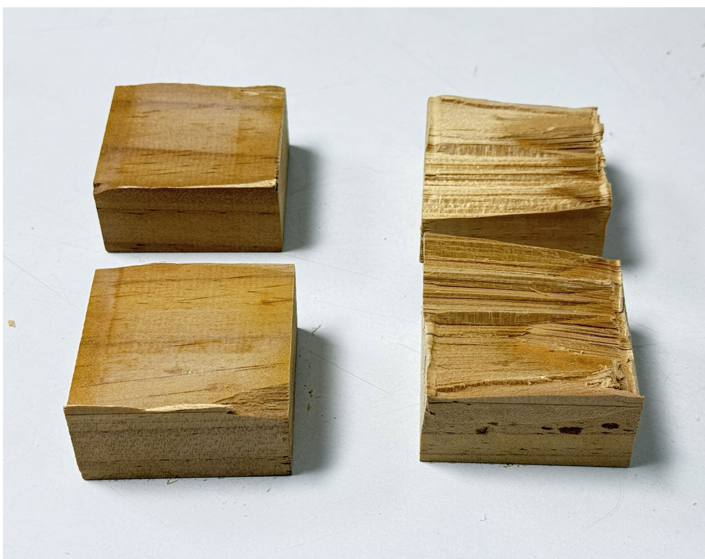
Figura 2. Montaje ensayo de cizalle y modos de falla: falla adhesiva en PUR (izquierda) y falla en la madera en EPI (derecha).
