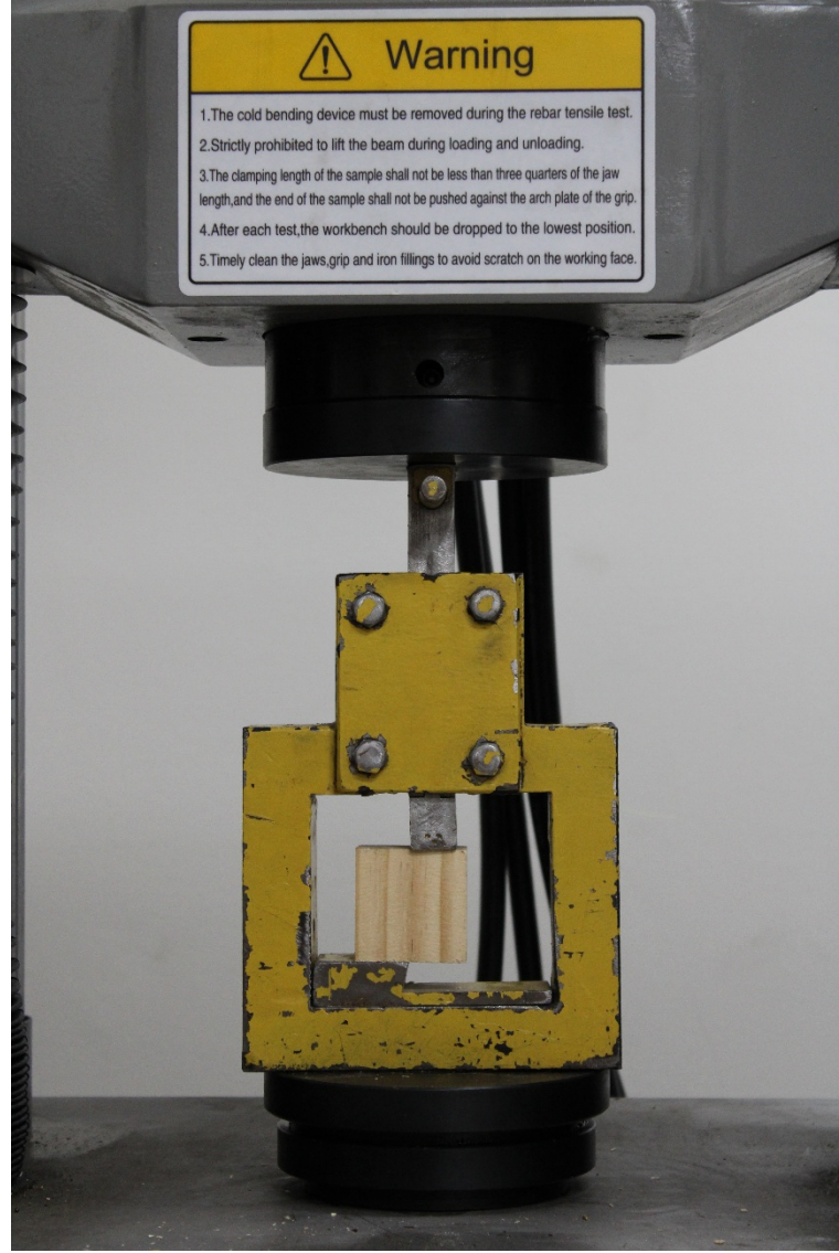
Figura 2. Montaje ensayo de cizalle y modos de falla: falla adhesiva en PUR (izquierda) y falla en la madera en EPI (derecha).
