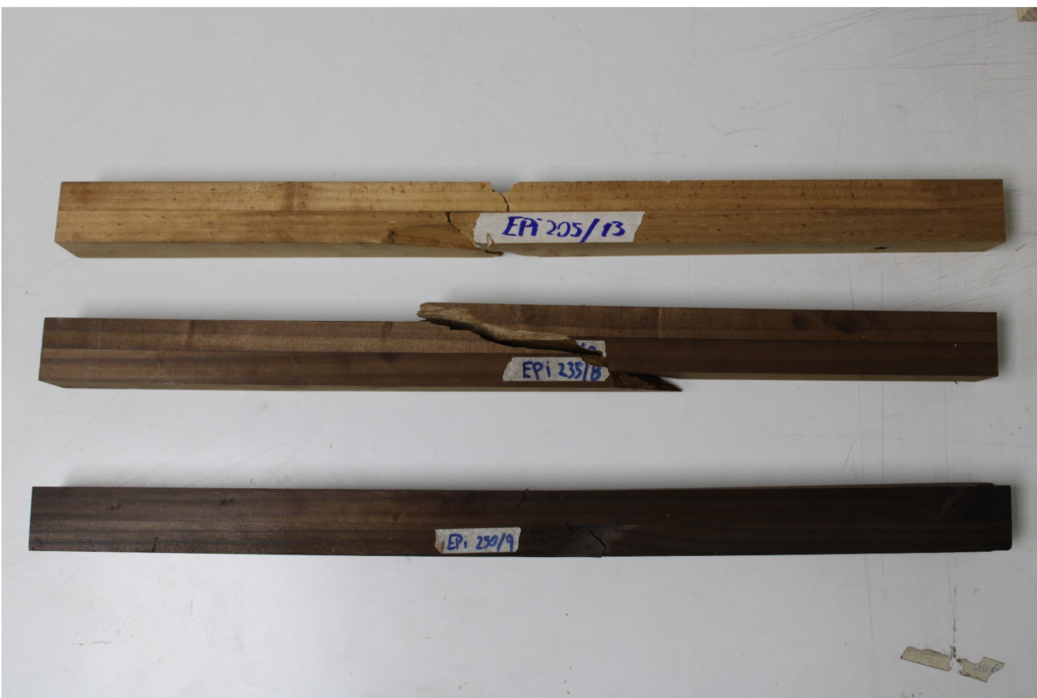
Figura 4. Fallas en probetas con adhesivo EPI (falla en la madera)
