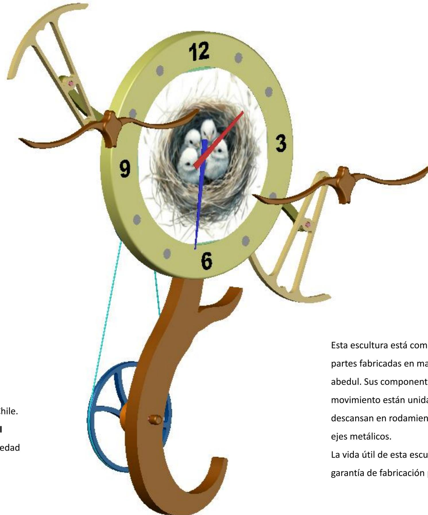
Esta escultura está compuesta por el 95% de sus partes fabricadas en madera de roble, pino y abedul. Sus componentes que le dan vida y movimiento están unidas a articulaciones que descansan en rodamientos sellados y soportados a ejes metálicos.
