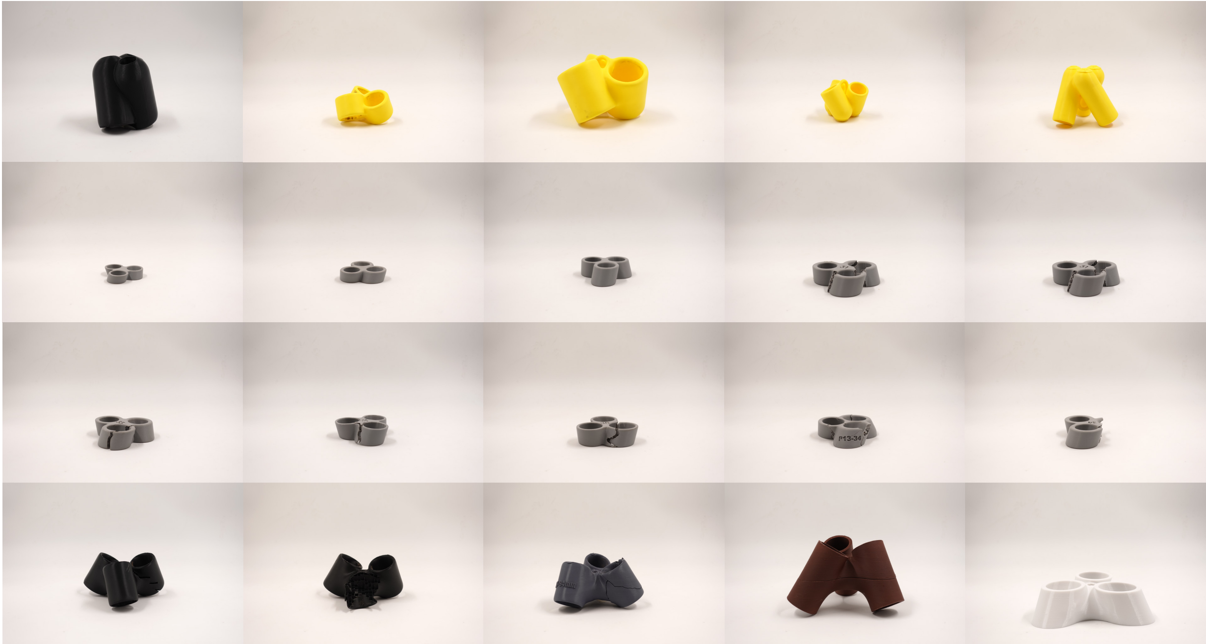
Selección iteraciones realizadas para el proceso de diseño del nodo 3D, observandose las fallas mecánicas luego de pruebas de ensamble y a exposición antes condiciones reales en terreno. - Fotografías.
