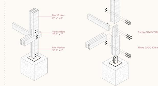
DETALLE 3B - Unión Pilar Fachada Norte
