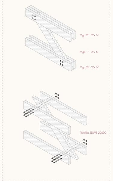
DETALLE 3A - Unión Pilar Fachada Sur
