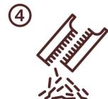
Con cardas metálicas se tamiza la corteza para obtener fibras.
