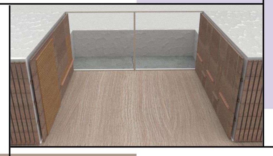
Un diseño simple que consiste en listones de Lenga pegados con cola a una chapa, los cuales son articulados por medio de una bisagra de madera cuyo eje es un perfil redondo.
