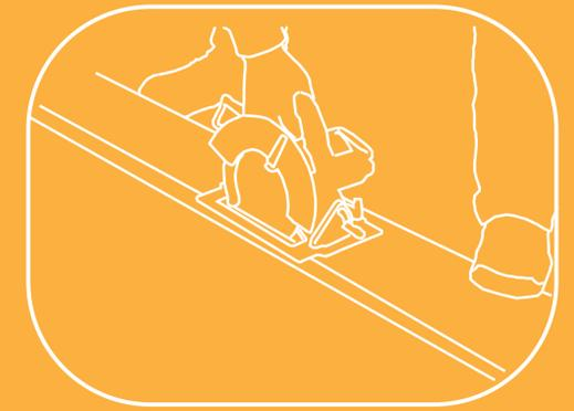
B) Se empieza realizando cortes verticalmente, estos no pueden llegar a cortar la madera completamente y deben de tener una separacion de un centimetro.
