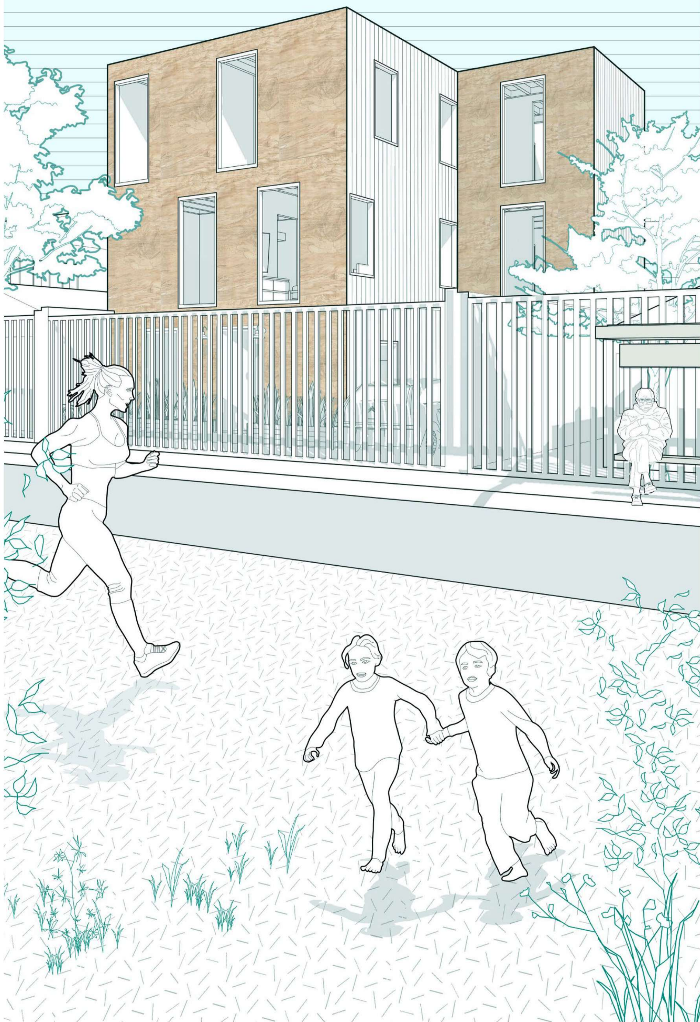
Imagen 1 Los muros texturizados corresponden a CLT. La casa tiene una relación directa con el parque Pierre dubois.
