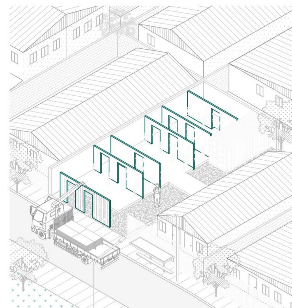
Montaje 2 Primero se instalan los paneles predimensionados de CLT, de forma rápida y eficaz con la ayuda de una grúa,
