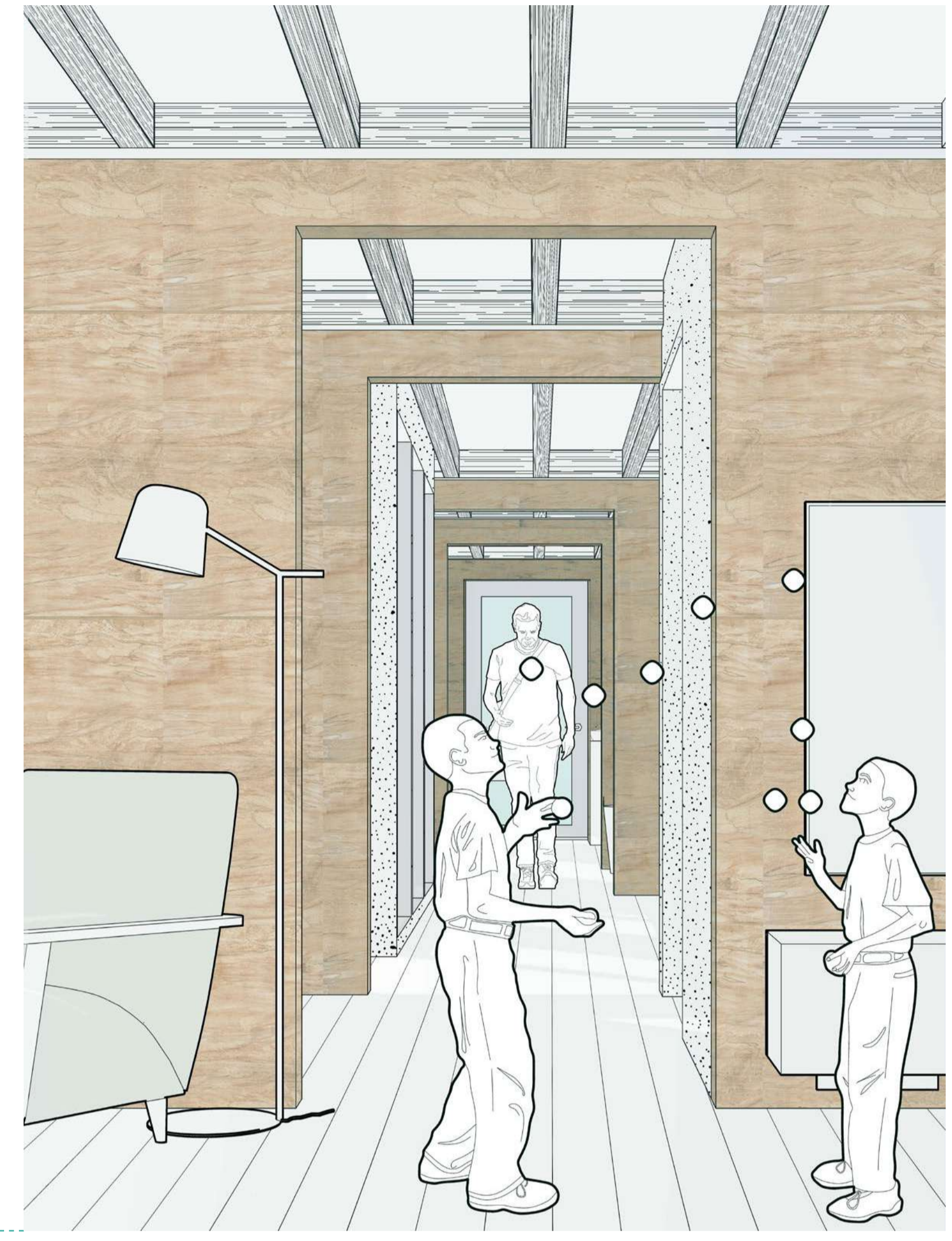
Imagen 2 Vista desde la sala de estar de la casa, en esta imagen se denota la característica principal del proyecto, la sucesión de muros de CLT.
