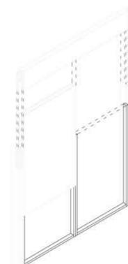
Al entender la madera como elemento prefabricado, utilizamos las medidas estándares para proponer un modulo hibrido de madera laminada y panel SIP, en donde el panel Sip es el principal modulador a partir de las medidas estándares 1,22 m x 2,44 m.
