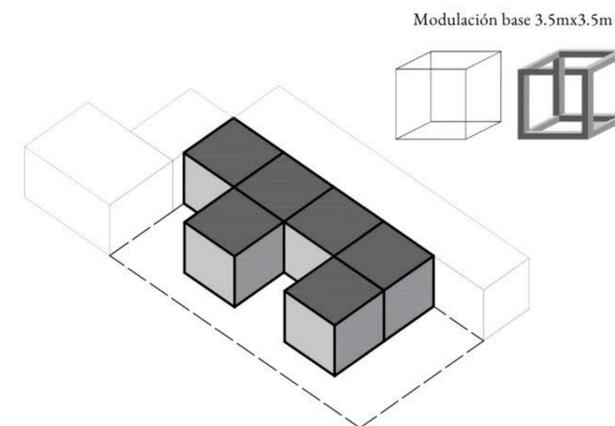
La estructura autoportante permite que el edificio adquiera ese dinamismo de sistema modular cúbico, ya que hace que la edificación pueda crecer de forma vertical y hacerse ampliaciones de forma horizontal, manteniendo llenos y vanos intercalados.
