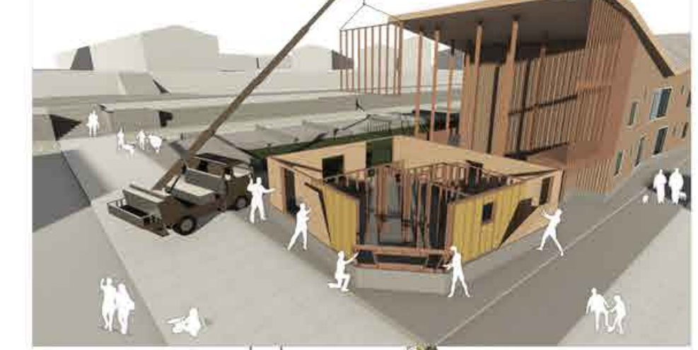
3. MONTAJE DE PANELES PERIMETRALES 4. MONTAJE DE PANELES INTERIORES
