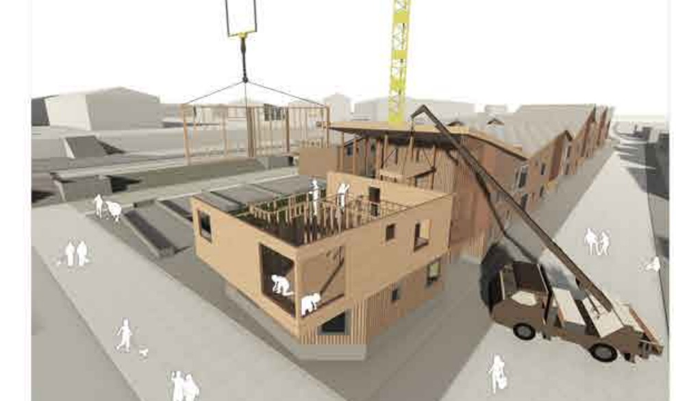
7. MONTAJE DE PANELES PERIMETRALES Y POSTERIORMENTE LOS INTERIORES
