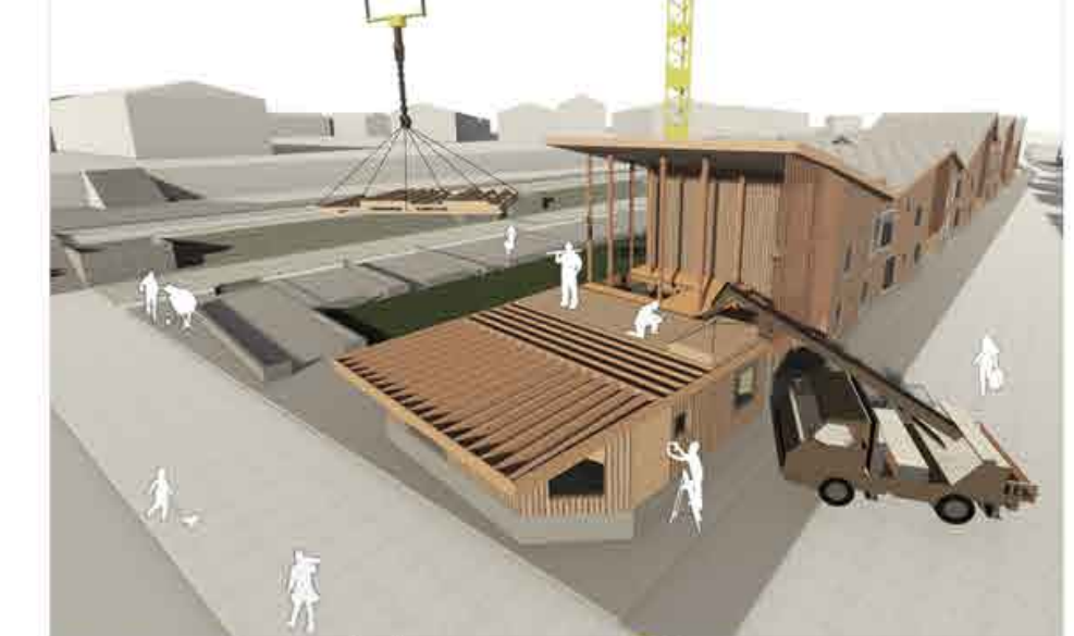
6. INICIO DEL MONTAJE DEL SEGUNDO NIVEL
