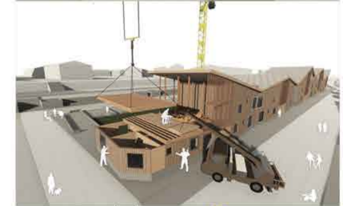
5. MONTAJE DE LAS VIGAS DE ENTRE PISO Y REVESTIMIENTO
