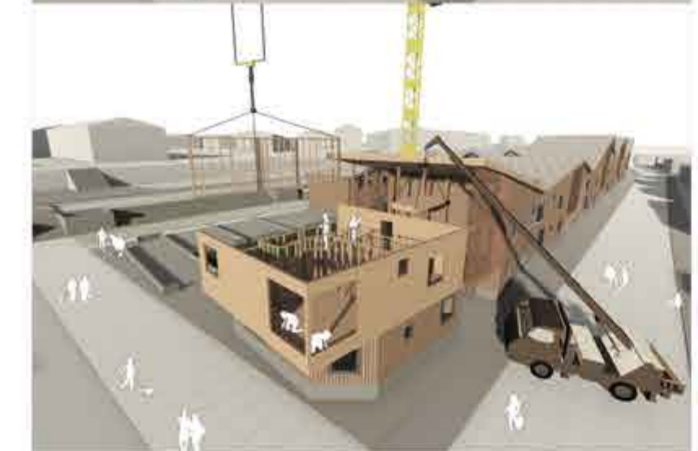
7. MONTAJE DE PANELES PERIMETRALES Y POSTERIORMENTE LOS INTERIORES
