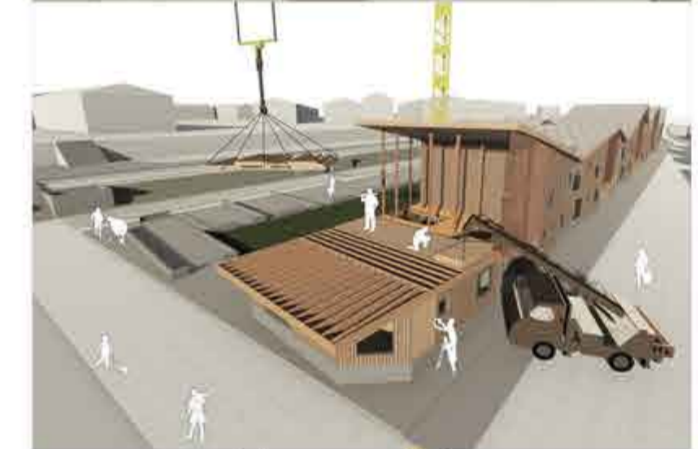
6. INICIO DEL MONTAJE DEL SEGUNDO NIVEL
