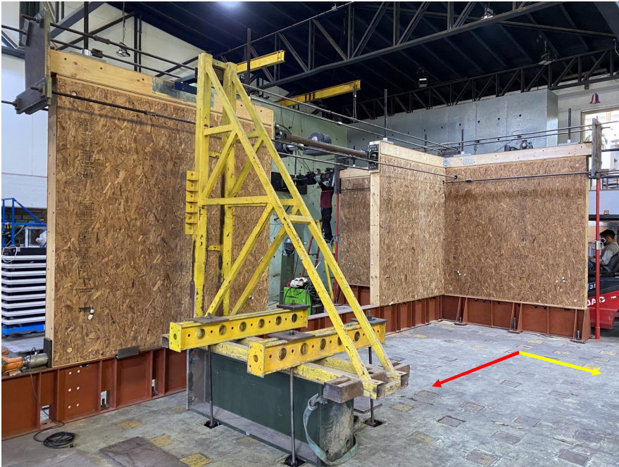
Figura 4: Prueba de concepto para estudiar el 3D-SWCE en muros no planares en T
