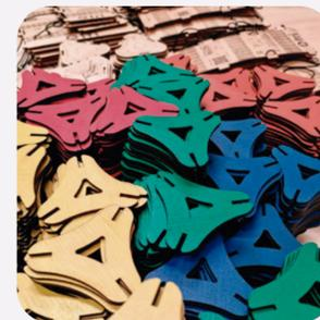
Cajas grabadas y cortadas en CNC láser listas para armar.
