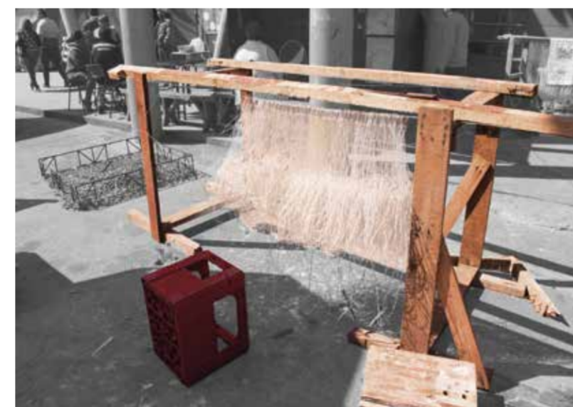
Caballete - estructura para apoyar espinel
