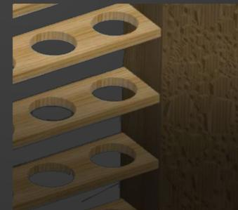
Para unir los separadores de cilindros se dejó 21,5 [mm] de la pieza como referencia, la cual se encaja en los marcos laterales.
