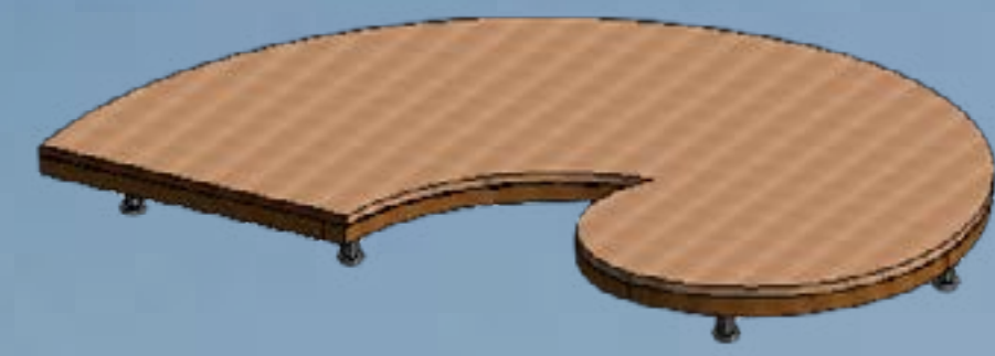
1. Entramado de vigas sobre soportes regulables.
