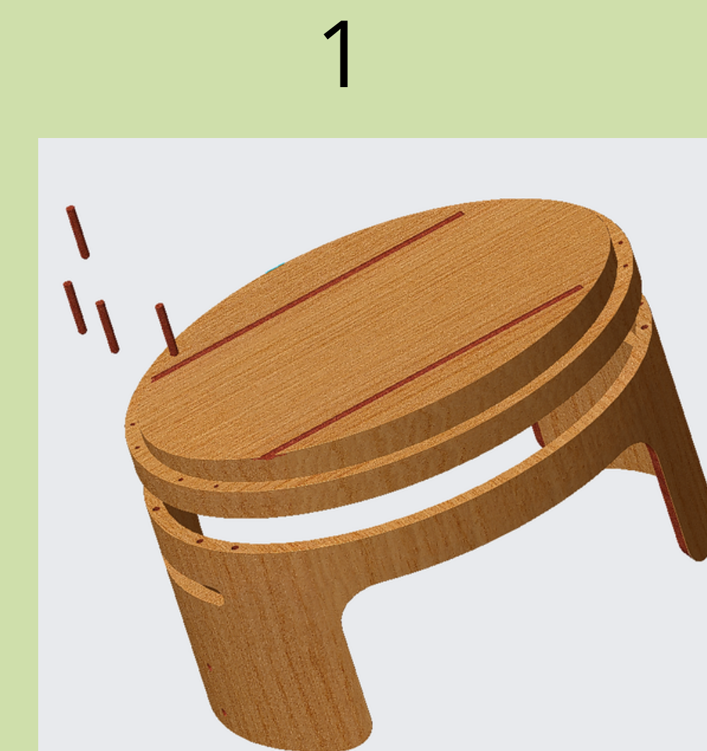
1 Se alinea la tapa con la carcasa ocupando los 4 pasadores de cada lado de esta dejándola completa y firme .
