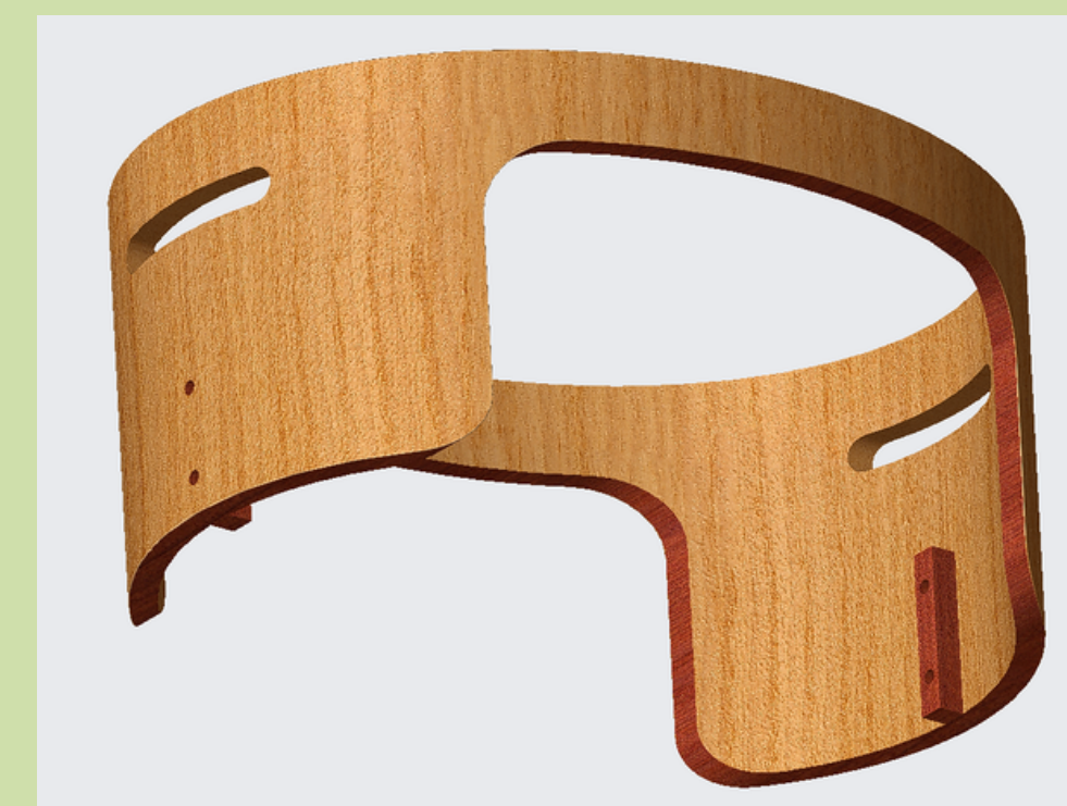
Carcasa principal que va en el centro de el objeto dandole la fuerza para aguantar el peso con 8 agujeros para los pasadores y 2 para los encajes.
