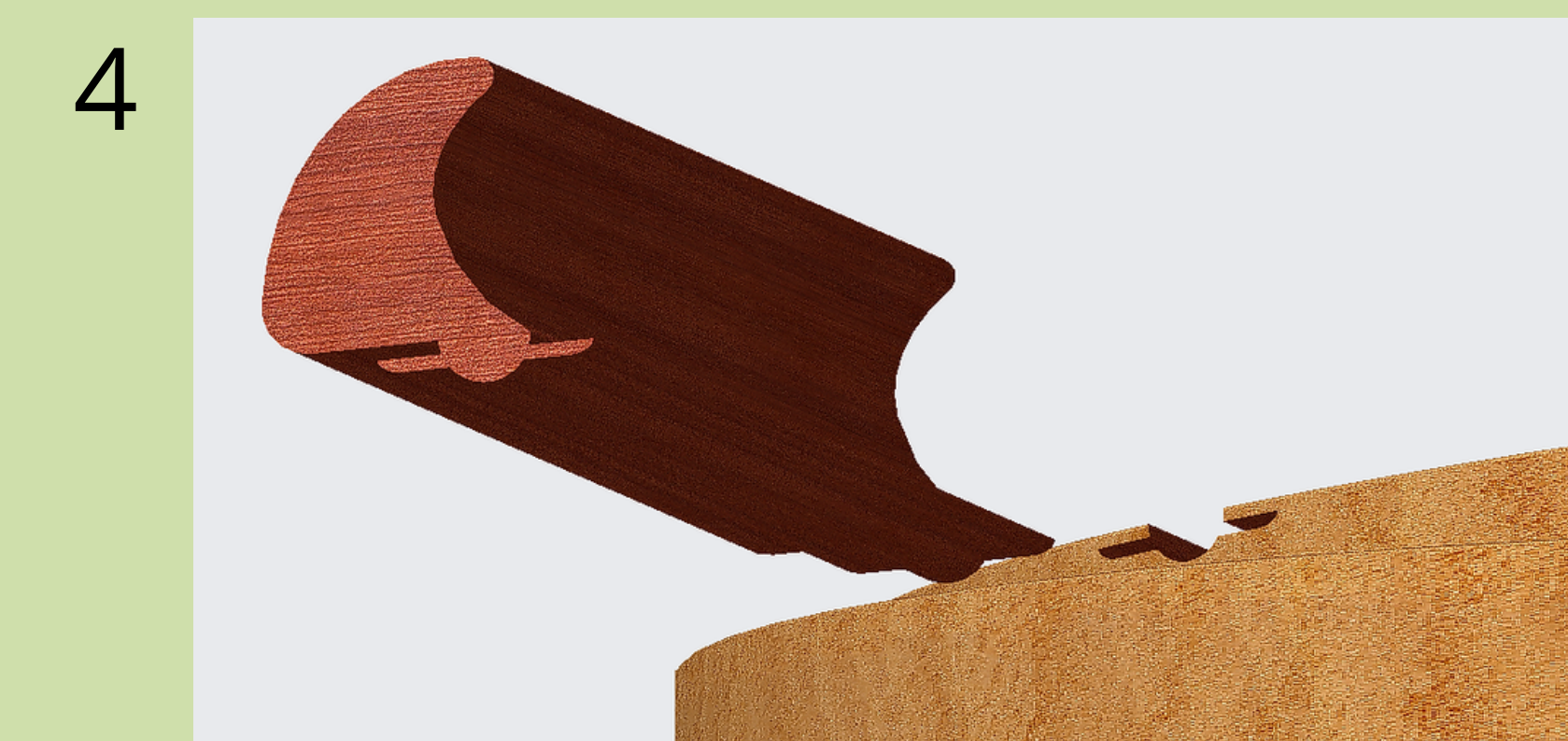
4 Y finalmente se introducen ambos encajes .
