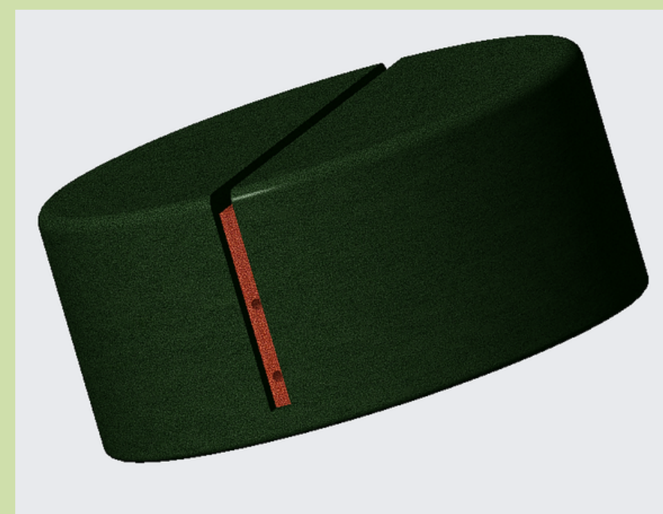
Colchado de memory foam cubierto de tela que va al interior de la carcasa con 2 agujeros para los encajes.
