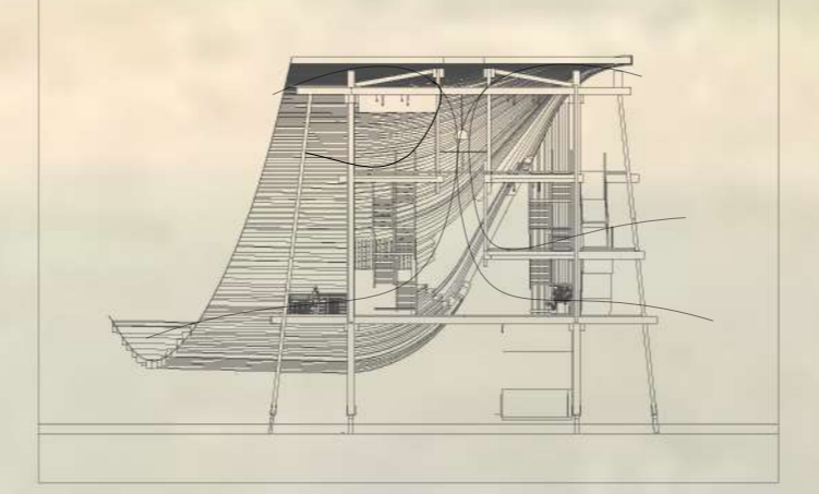
Corte esquemático de caída de Ventilación
