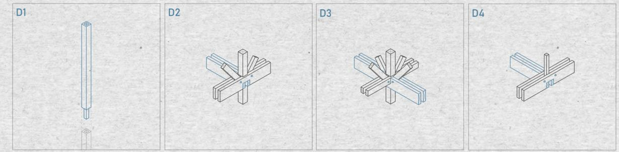
D1: Los pilares poseen encajes con los cuales permiten recibir los diferentes cruces de vigas.
