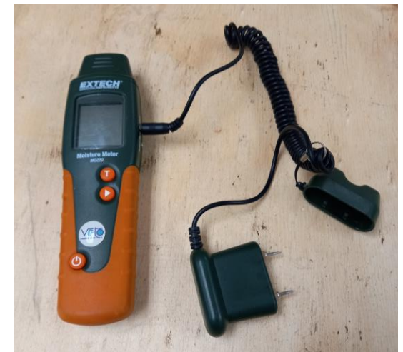
Figura 10: Aparato para medir humedad.
