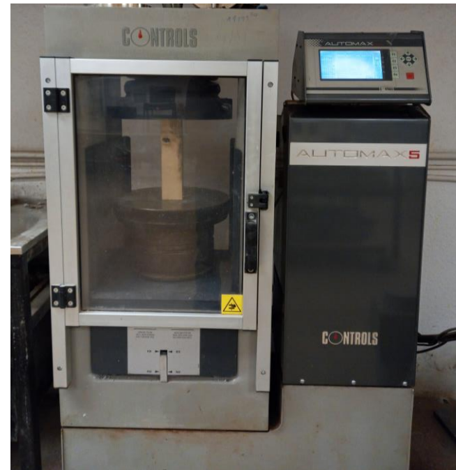
Figura 9: Máquina de ensayo para compresión.
