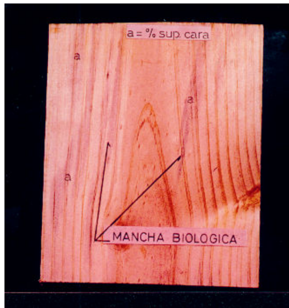
Figura 13.5 Presencia de la mancha azul o mancha biológica en la madera.
