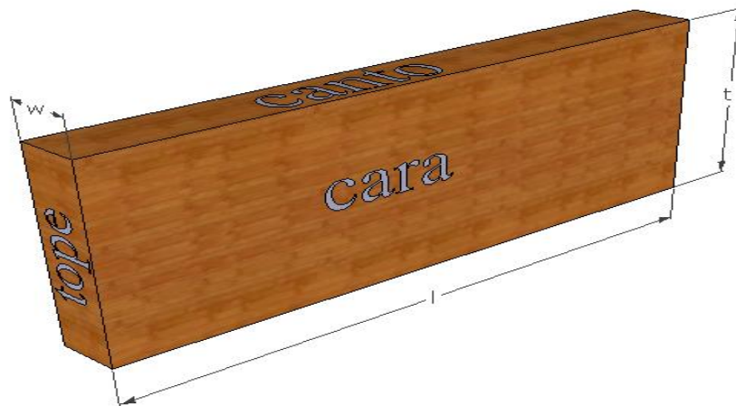
Figura 7.1: Nomenclatura de los lados de un tablón de madera.
