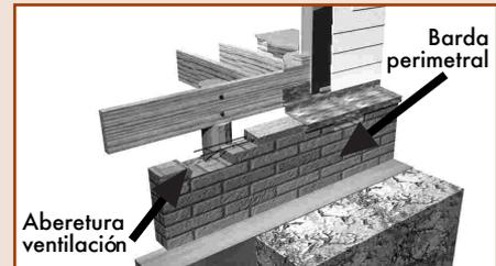
5. Fundación en pilotes, con barda perimetral con aberturas para la ventilación de plataforma.
