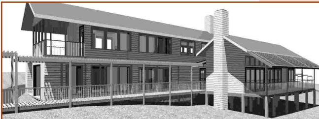
4. Edificación de plataforma de madera sobre pilotes.
