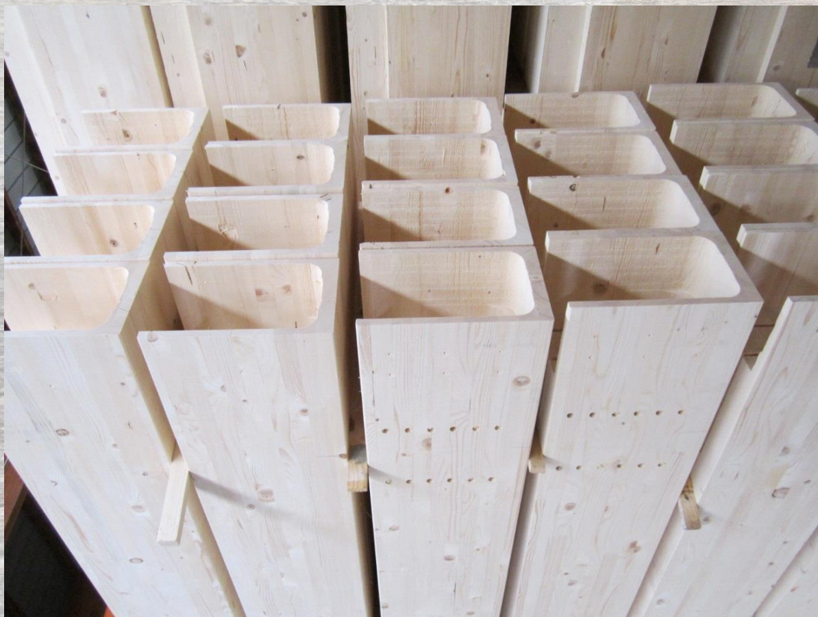
VIGAS RANURADAS PARA RECIBIR PLACAS MEDALLAS | BEAMS GROOVED TO RECEIVE METAL PLATES
