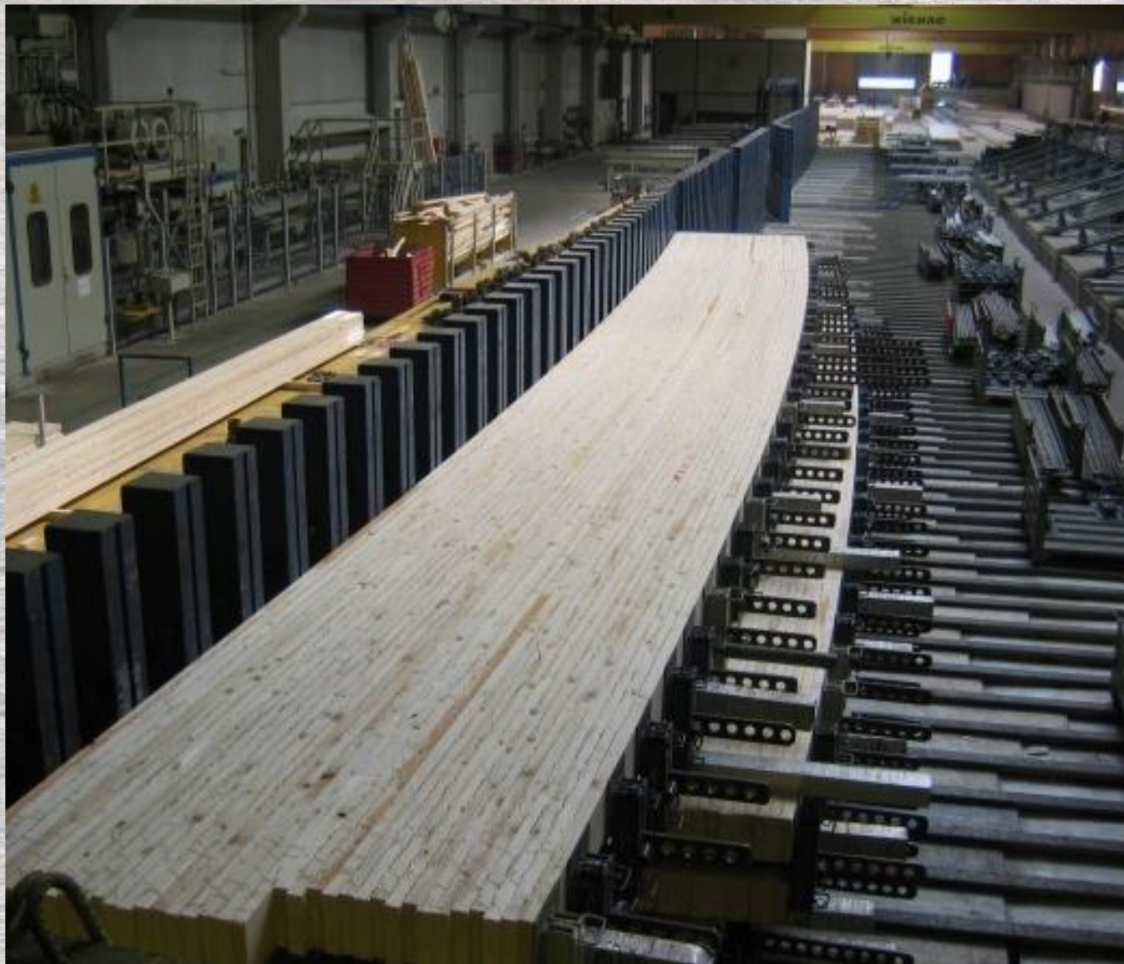
ENCOLAMIENTO DE VIGAS | GLUING VICE
