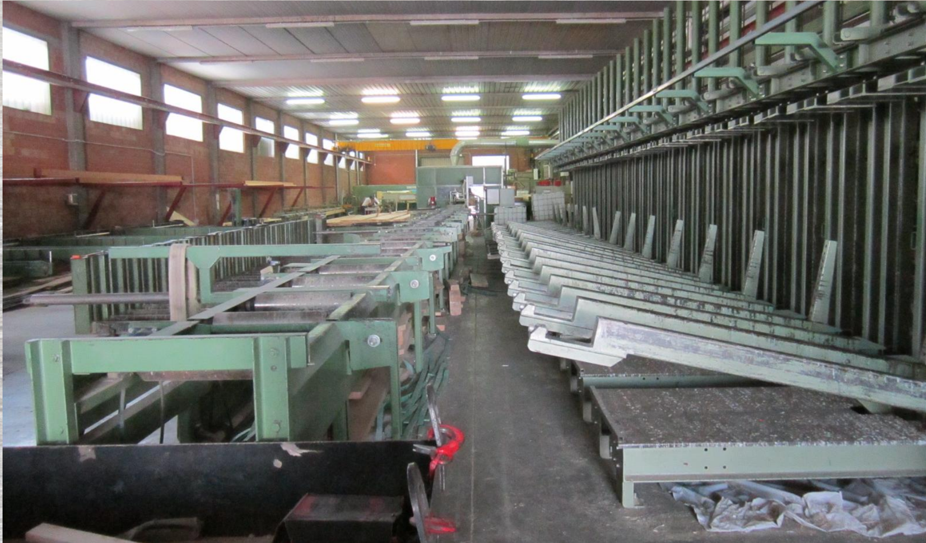
ENCOLAMIENTO DE VIGAS | GLUING VICE
