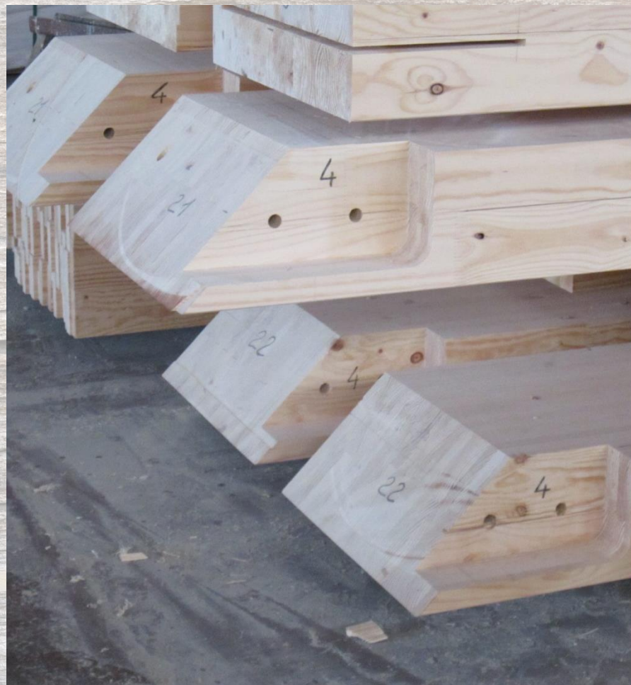
CALADOS EN VIGAS PARA RECIBIR PLACAS MEDALLAS | BEAMS GROOVED TO RECEIVE METAL PLATES
