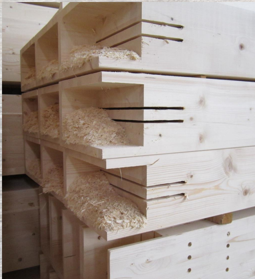
CALADOS EN VIGAS PARA RECIBIR PLACAS MEDALLAS | BEAMS GROOVED TO RECEIVE METAL PLATES
