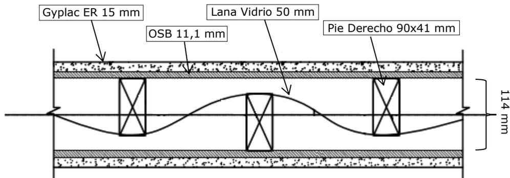
Descripción : Estructura en madera de pino conformado por pie derechos de 41x90 mm instalados en trebolillo y separados cada 40 cm y soleras de pino de 41x114 mm con lana de vidrio Romeral rollo libre de 50 mm de espesor, densidad 11 kg/m<sup>3</sup> y factor R100 de 122. Esta estructura lleva en ambas caras, una placa de OSB de 11,1 mm y una placa de yeso cartón Gyplac ER de 15 mm.
