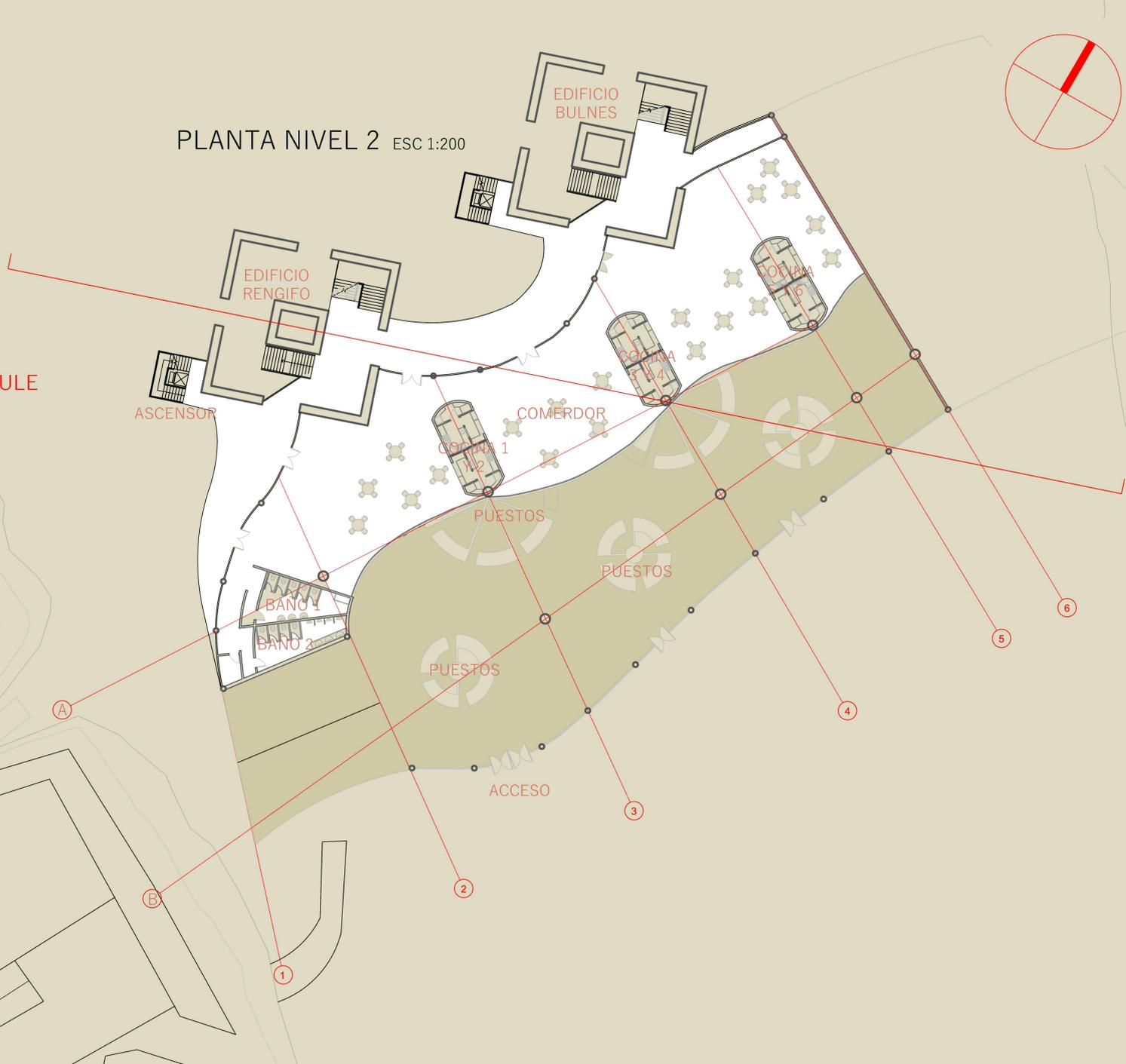
El mercado fluvial en su definición está desarrollado con arquitectura paramétrica y su cubierta está fabricada con paneles de CLT curvado in situ con una capa superior habitable de LVL, y su programa se destaca la fluidez de la organización espacial lograda por la disposición de su mobiliario, en sintonía con su lenguaje líquido presente en todas sus dimensiones a través de la flexibilidad que permite la madera.
