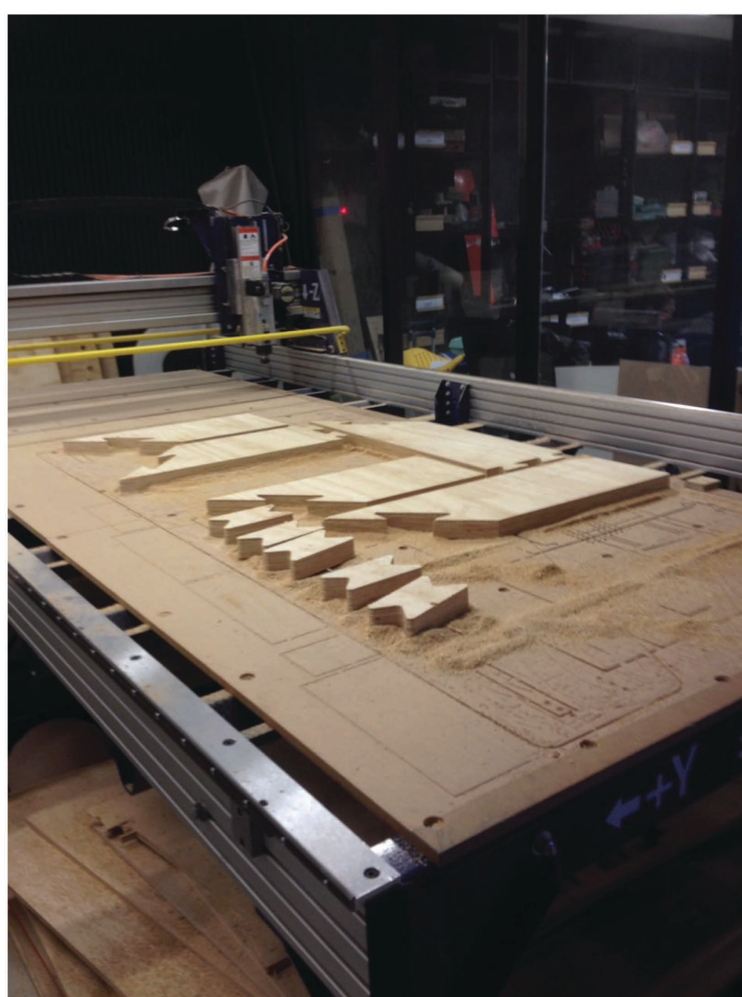
a) Corte de las piezas de LVL en CNC
