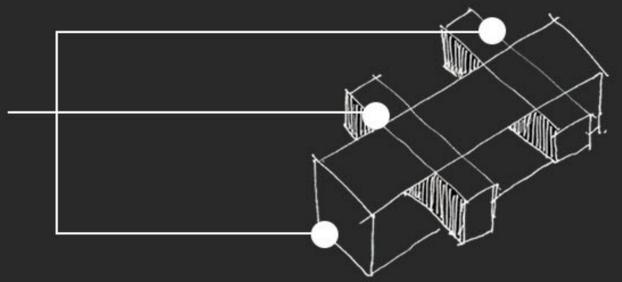
El entramado principal de estos cuerpo es el que determina las áreas estructurales -núcleos- primordiales en el proyecto. Los que son utilizados para la circulación vertical- escaleras y ascensores- son éstos los que llegan hasta un socalo el que tiene relación directa con el suelo. El bloque principal se levanta y da posibilidad a una planta libre, de uso público.
