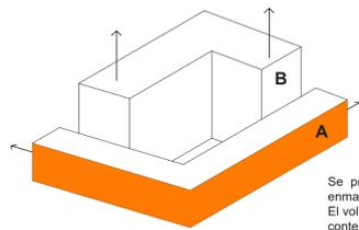
Se proponen 2 volúmenes que enmarcan un vacío central. El volumen "A" sigue la escala de contexto, manteniendo la fachada continua y reinterpretando elementos arquitectónicos de Iquique como la veranda y techo aéreo. El volumen "B" se lleva a altura máxima.
