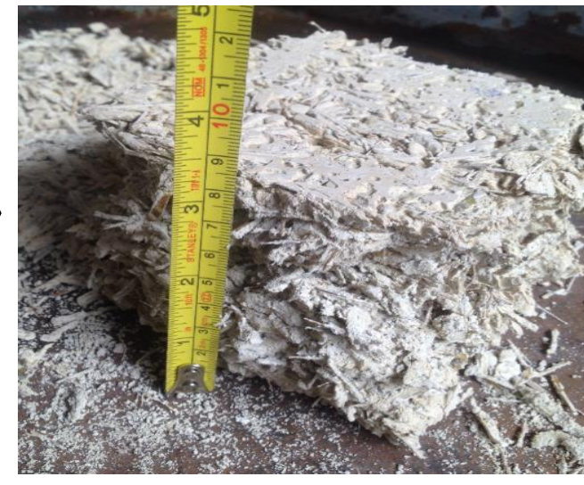
Fig. 14: Probeta P13 ensayada a la compresión.
