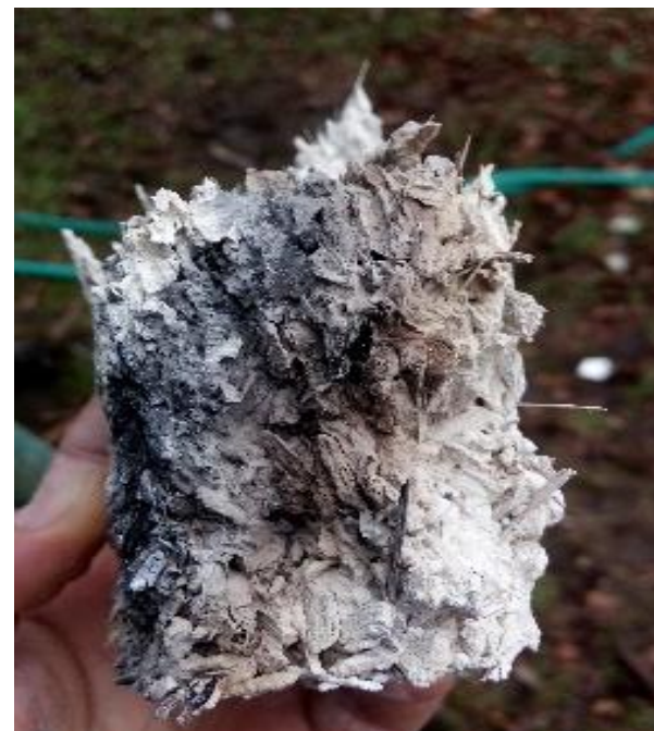
Fig. 23: Material luego de ser sometido 50 min a una tempera de aproximadamente 1500 °C.
