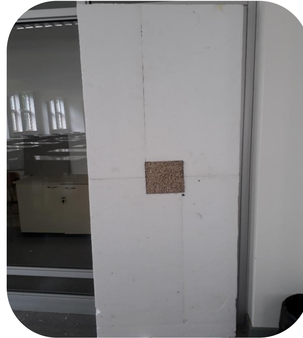
Fig. 17: Base de polietileno expandido mas probeta hexaédrica P2'.
