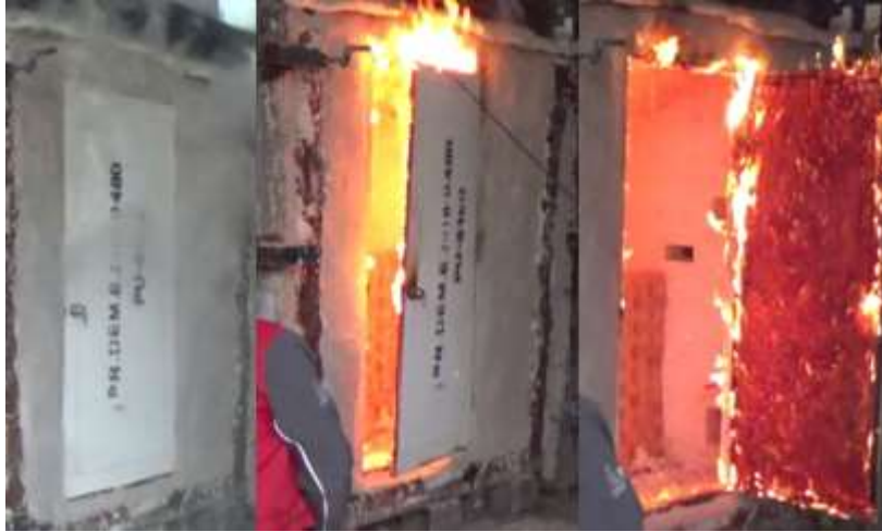
Figura 4: FirstFire Wood impregnado en puerta puesta a prueba a IDIEM.
