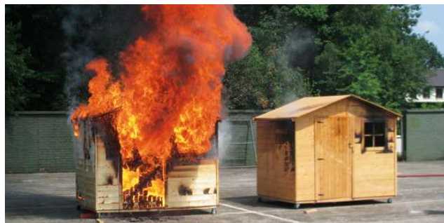
Figura 5: Ejemplo de accion ignifuga en casa prefabricada.
