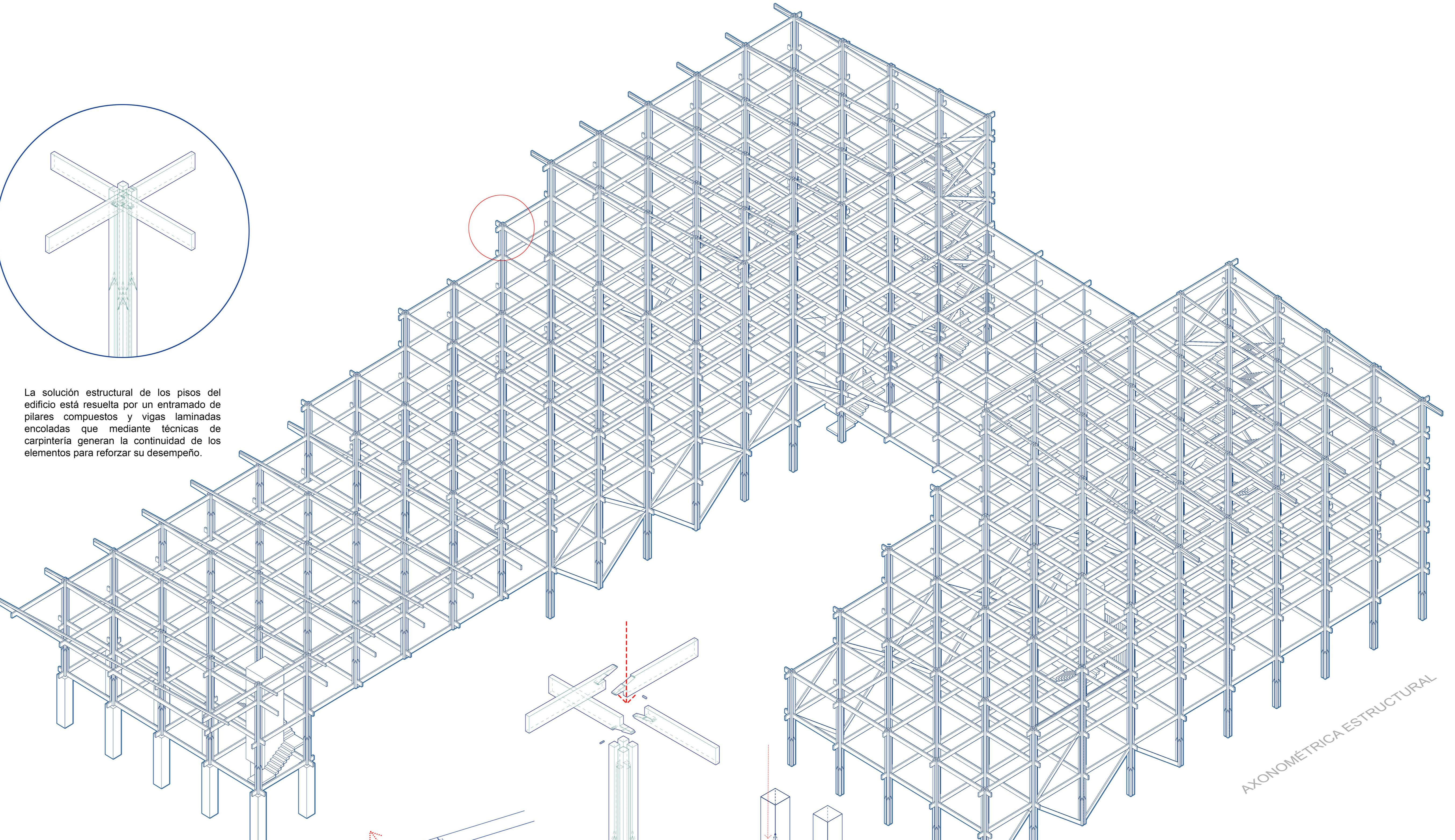
La continuidad de las vigas se soluciona mediante una unión tipo Scarf Joint, técnica de carpintería que no requiere herrajes, y que se refuerza con encolado.
