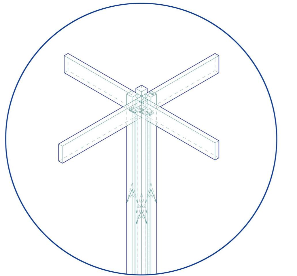
La solución estructural de los pisos del edificio está resuelta por un entramado de pilares compuestos y vigas laminadas encoladas que mediante técnicas de carpintería generan la continuidad de los elementos para reforzar su desempeño.
