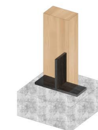
Union fundacion pilar
