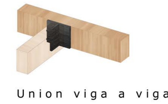
Union viga a viga
