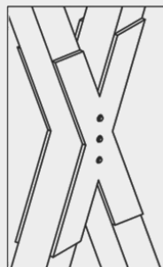
2.-Unión de placa de acero con pernos de 1 1/2" v
