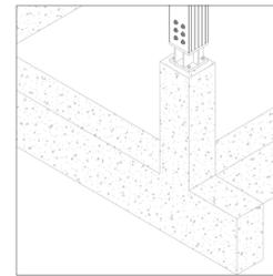
**DETALLE 06 FUNDACION DE HORMIGON ARMADO**
